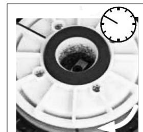
Слегка надавите на камень сверху и прокрутите один полный оборот, а затем ешё до положения «10 часов» до его полной остановки.
