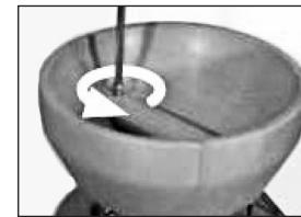
Снимите бункер для зерна.
