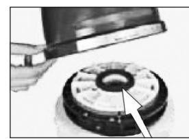
Проверьте правильность положения резинового уплотнительного кольца. Установите бункер на место, закрутите крепёжный винт и ручку настройки помола.
