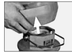
С двух сторон выкрутите винты крепления ручки настройки помола примерно на 12 мм.
