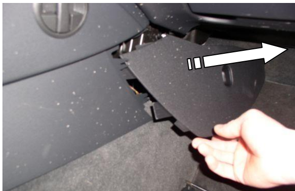
Снять боковые крышки с обеих сторон
