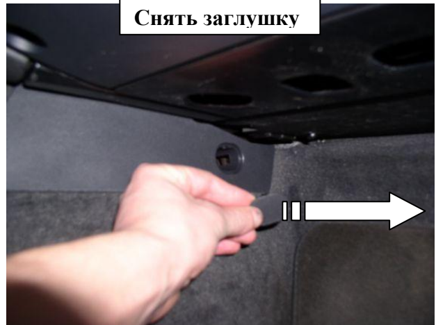
Снять боковую крышку
