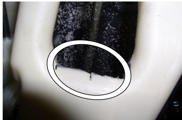
Удалить мешающий пластик селектора
