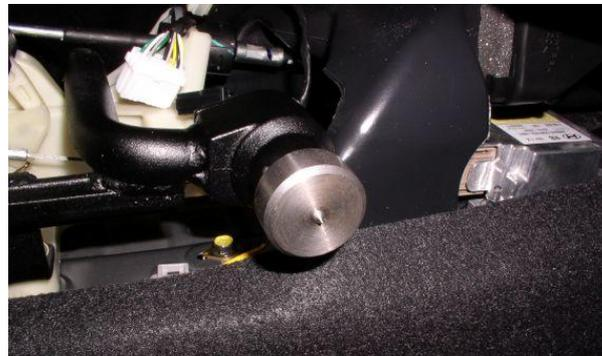
Разметить в консоли отверстие под корпус замка с помощью шаблона
