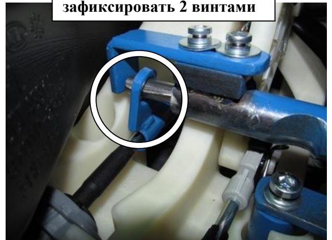
Перевести рычаг переключения передат в положение «R», произвести блокировку, отрегулировать положение хомута на тяге, сорвать 2 винта
