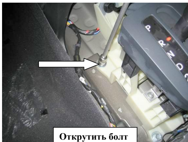
Снять верхнюю крышку и консоль
