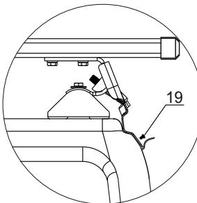
1. Установить стойки багажника пластиковой подошвой на крышу автомобиля на расстоянии 1см от ребра крыши напротив штатных мест.
