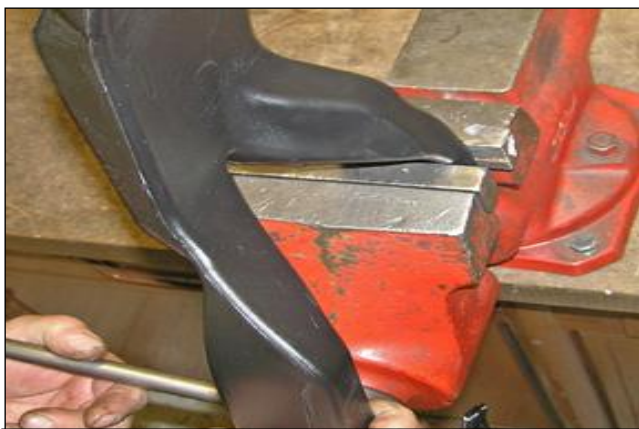
Загерметизировать воздуховод в тисках, предварительно нагрев конец феном
