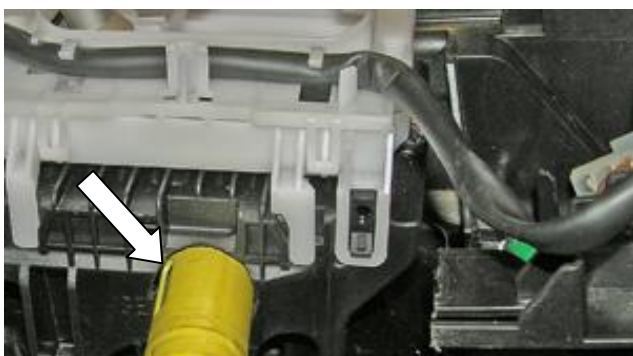
Приложите замок (поз. 1) по посадочным местам, разметьте и просверлите отверстие ф 22мм в стенке селектора
