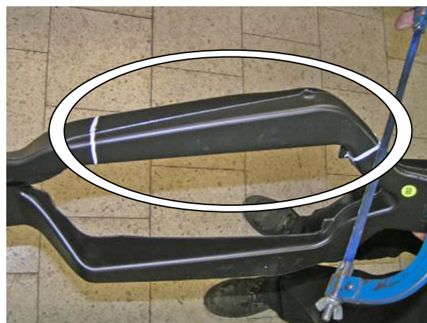
Удалить мешающий пластик воздуховода
