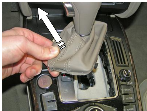
Снять декоративный кожух
