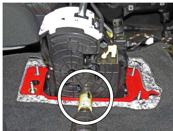
Просверлить в селекторе отверстие 22 мм. под трубу замка
