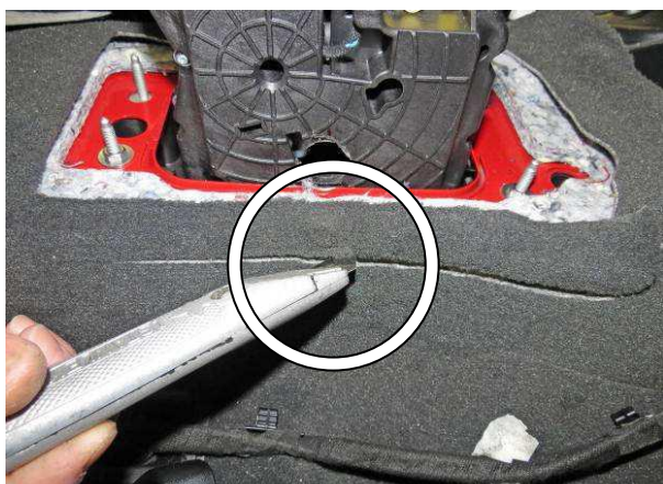
Удалить мешающий установке замка ковролин
