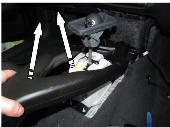
Снять воздуховод, снять звукоизоляционный кожух
