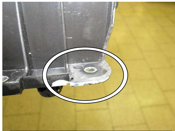
Удалить часть держателя консоли, установить держатель на место
