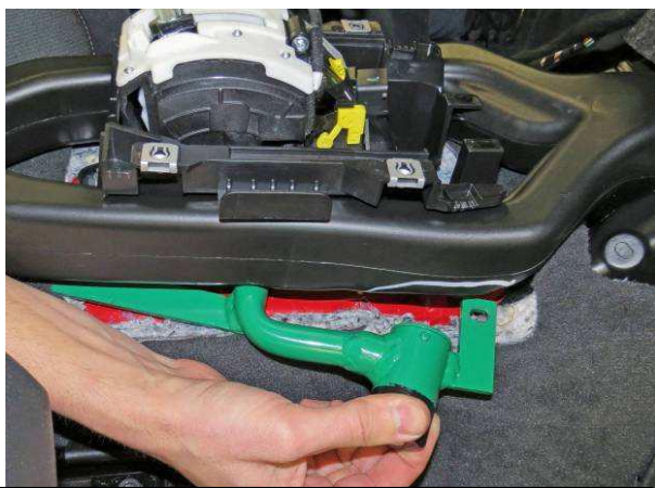
Установить замок трубой в отверстие
