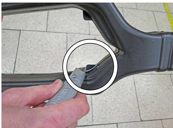
Удалить мешающие части воздуховода, установить воздуховод на место
