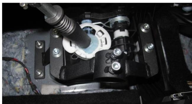
Установите замок (поз. 2), закрепив болтами (поз. 8) с шайбами (поз. 11)
