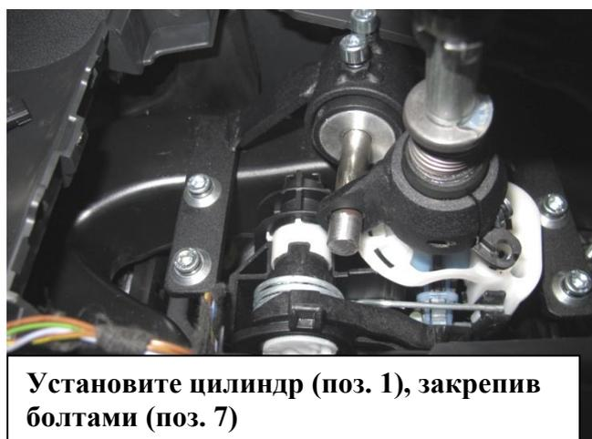
Установите цилиндр (поз. 1), закрепив болтами (поз. 7)
