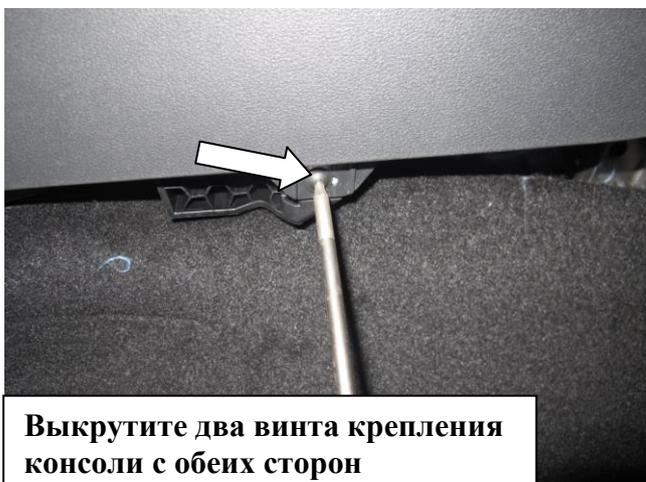
**Выкрутите два винта крепления консоли с обеих сторон**
