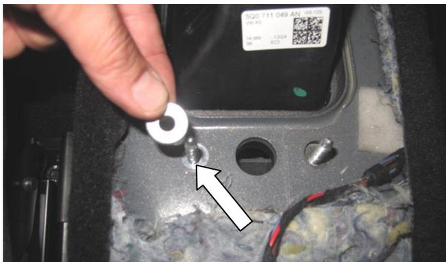
Подложите шайбу (поз. 10) на шпильку крепления селектора
