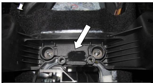
Установите кронштейн (поз. 3) на шпильки крепления селектора, закрепив гайками (поз. 9)
