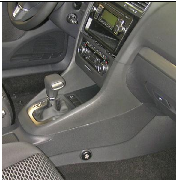
Разметить в консоли отверстие под корпус замка с помощью разметочного шаблона, просверлить отверстие, установить консоль на место
