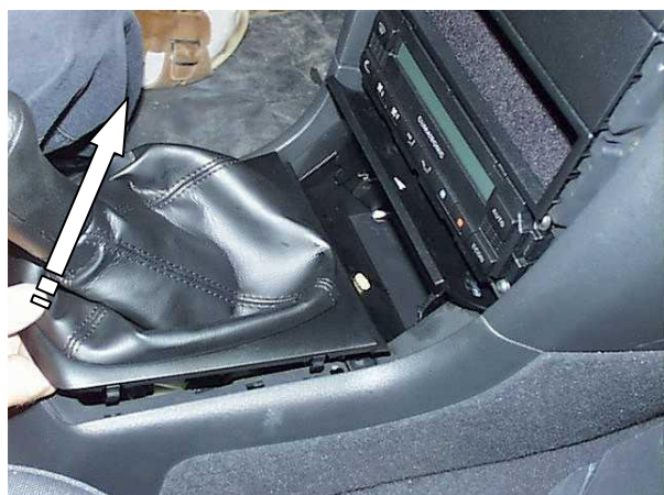
Снять декоративный кожух рычага переключения передач
