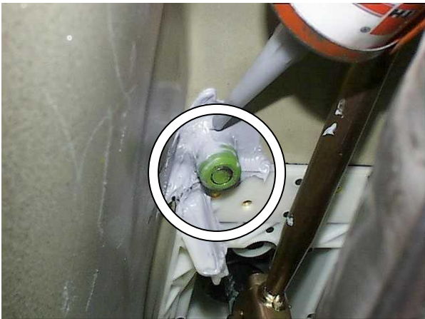
Вернуть замок на место, сорвать гайки, загерметизировать отверстие в днище герметиком
