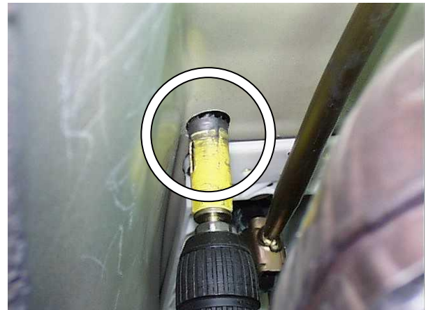
Расширить отверстие до 22 мм.
