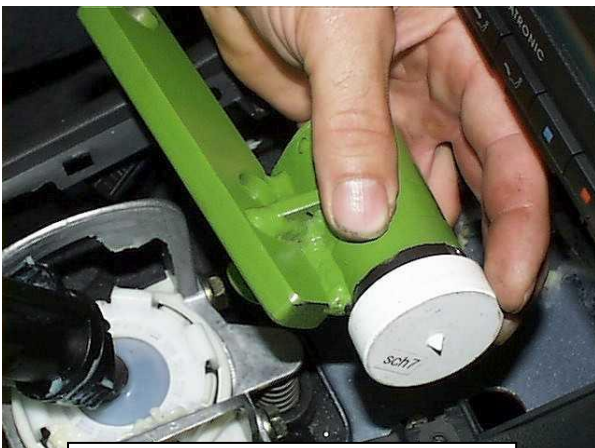
Установить на корпус замка разметочный шаблон
