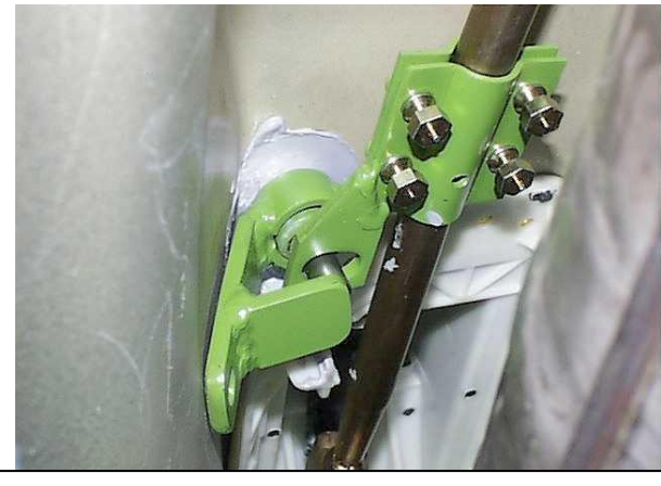
Перевести рычаг переключения передач в положение «R», произвести блокировку, отрегулировать положение хомута на тяге
