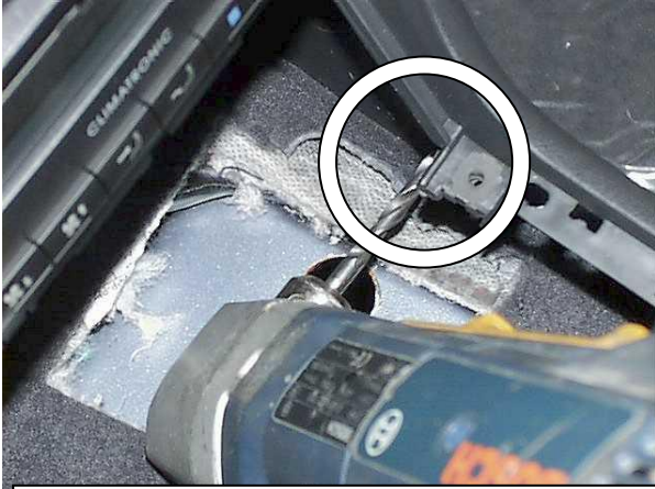
Снять замок, просверлить отверстие
