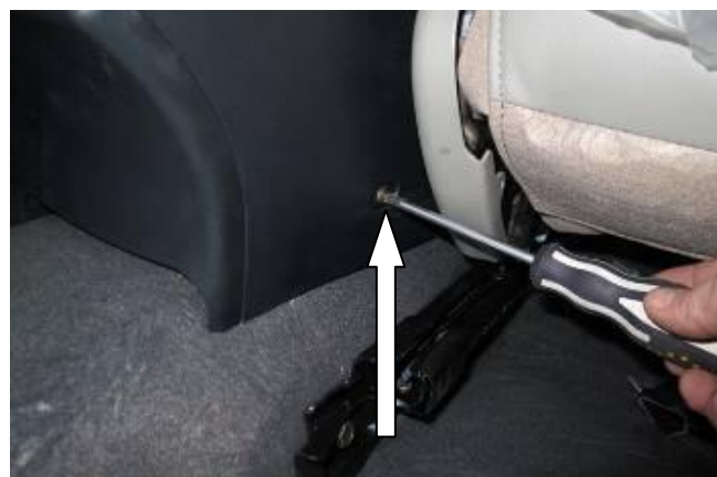
Сдвинуть передние кресла до упора вперёд, открутить саморезы с обеих сторон
