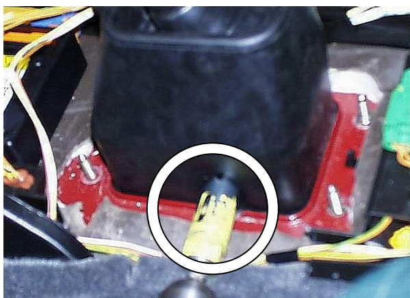
Просверлить отверстие в селекторе под трубу замка, удалить мешающую звукоизоляцию вокруг селектора
