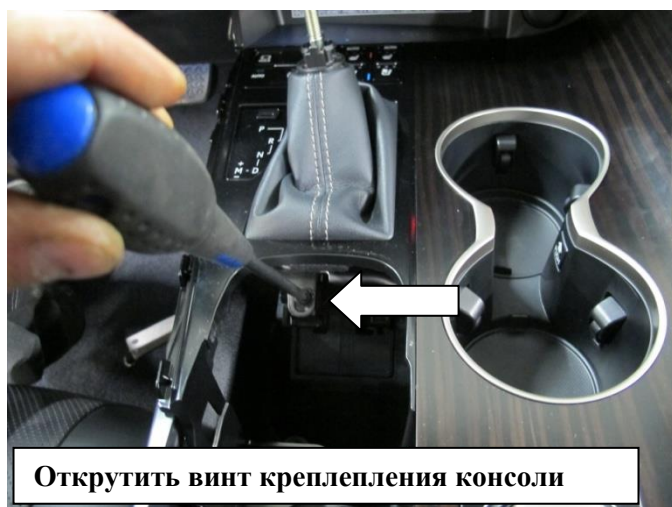
Снять накладку консоли
