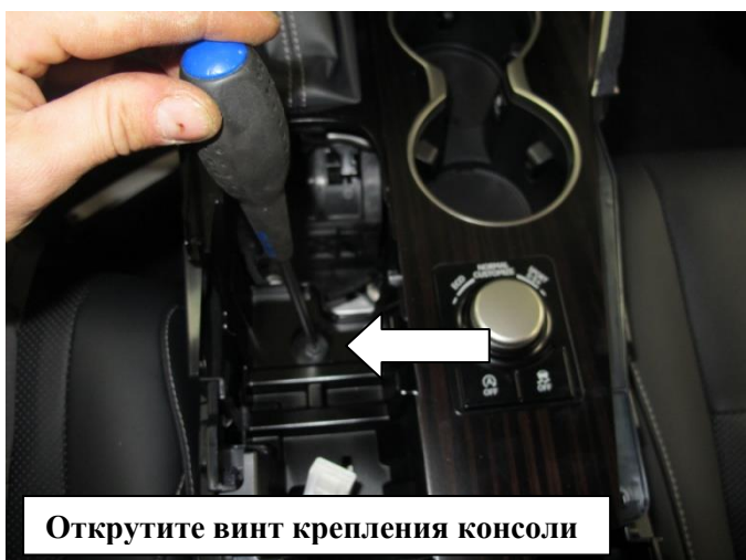
Открутить винт крепления консоли
