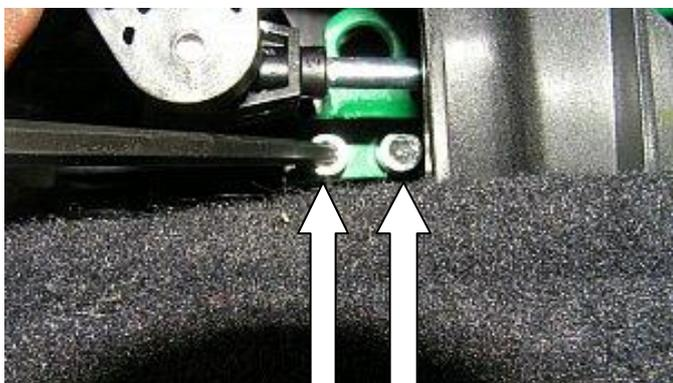
Перевести рычаг переключения передач в положение «R», произвести блокировку, отрегулировать положение хомута на тяге, сорвать винты
