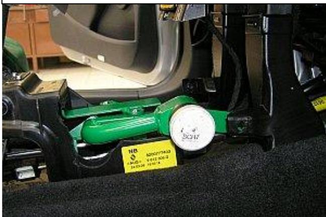
Разметить отверстие в консоли под корпус замка, используя разметочный шаблон
