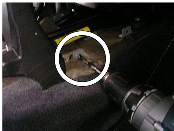
Расширить отверстие до 9 мм.
