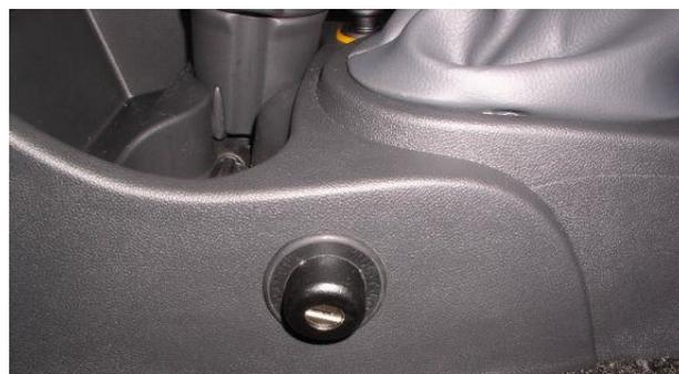
Разметить, используя разметочный шаблон, и просверлить в консоли отверстие под корпус замка, установить консоль на место
