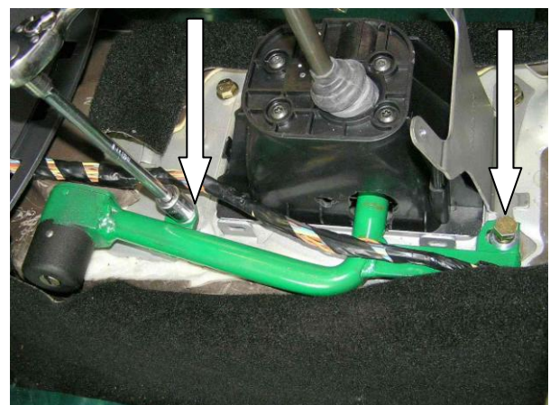
Установить замок трубой в отверстие, перевести рычаг переключения передач в положение «R», произвести и проверить блокировку, закрутить 2 срывных болта
