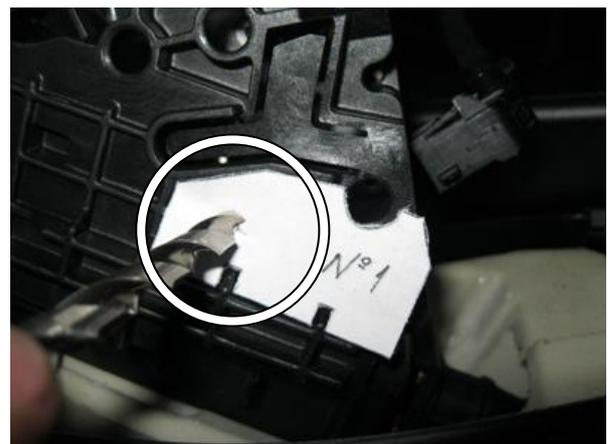
Просверлить отверстие 6 мм. по разметке
