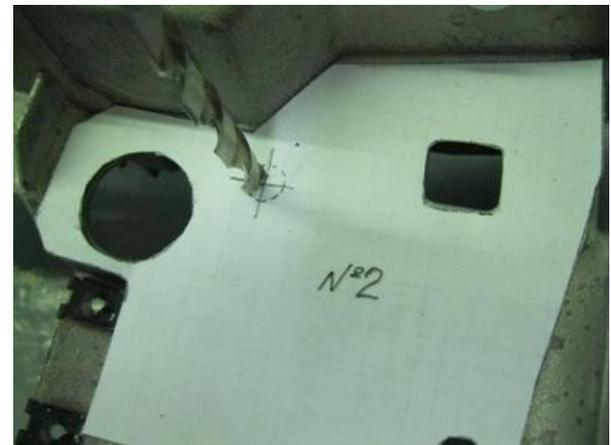
Просверлить отверстие 9 мм. по разметке
