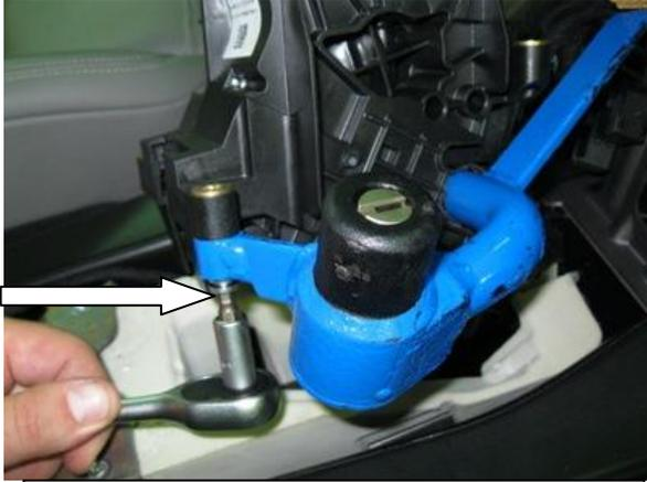
Установить замок на селектор трубой в отверстие, зафиксировать срывным болтом 10 мм.
