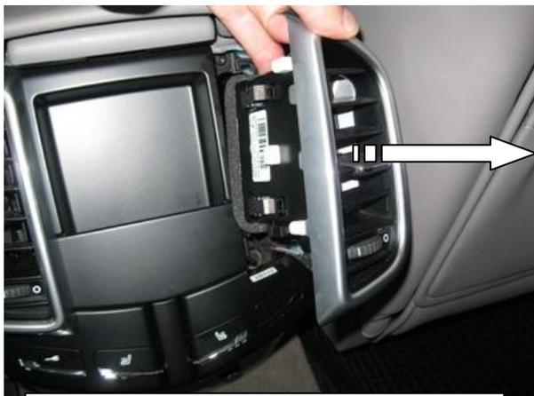
Снять решётку воздуховода сзади
