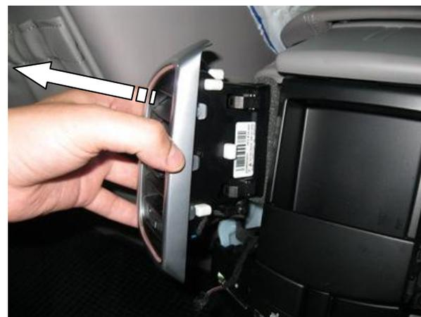
Снять решётку воздуховода сзади
