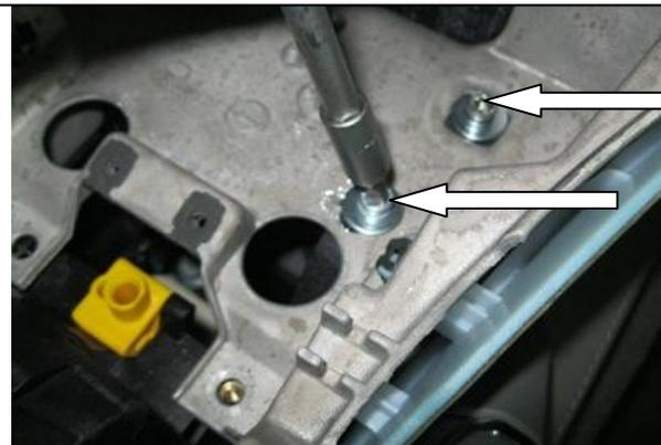
46 Зафиксировать лапку замка на консоли через отверстие 9 мм. болтом 10 мм. Зафиксировать консоль срывным болтом 20 мм. 46
