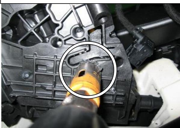
Снять шаблон, расширить отверстие до 22 мм.
