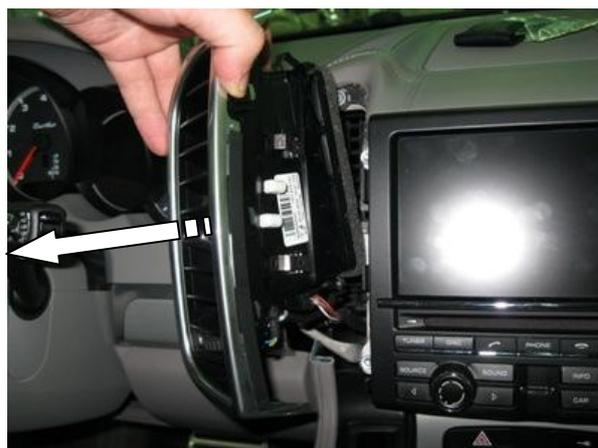
Снять решётку воздуховода спереди
