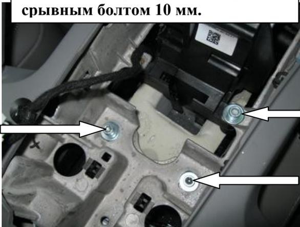
45 Установить консоль на место, зафиксировать 3 срывными болтами 20 мм. 45
