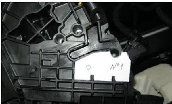
Распечатать 3 шаблона по ссылке [www.constructrus.ru/userfiles/file/PCF1623\\_Porsche\\_Cayenne.zip](http://www.constructrus.ru/userfiles/file/PCF1623_Porsche_Cayenne.zip), для печати в масштабе 1:1 отменить масштабирование на принтере, наклеить на селектор шаблон №1
