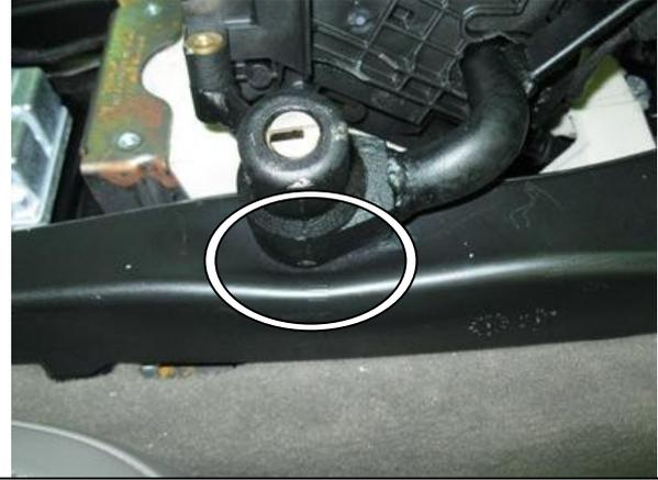
44 Установить воздуховод, разогрев феном и сформировав выемку под корпус замка, либо вырезать и герметизировать выемку скотчем 44
