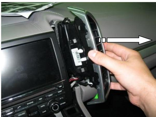
Снять решётку воздуховода спереди
