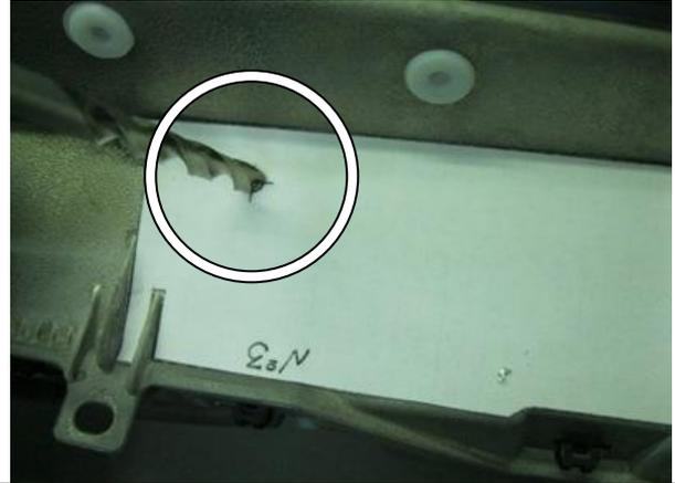
Просверлить отверстие 6 мм. по разметке
