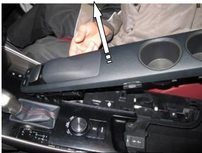
Снять верхнюю крышку
