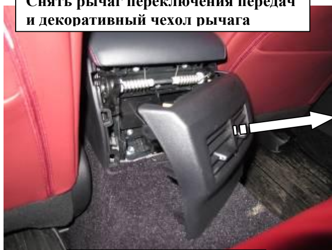
9 Снять заднюю крышку
