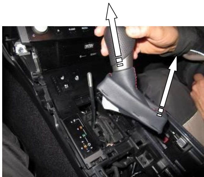
7 Снять рычаг переключения передач и декоративный чехол рычага
