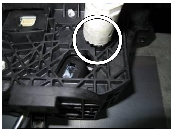
12 Просверлить в стенке селектора отверстие 22 мм. под трубу замка
