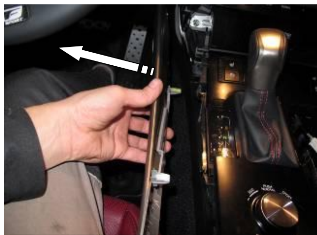
Снять боковые крышки с обеих сторон
