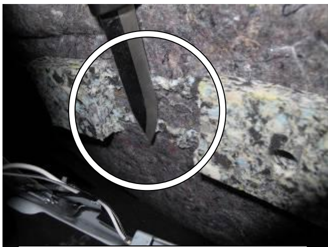
Удалить мешающую звукоизоляцию
