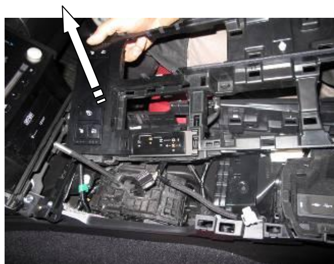
8 Снять внутреннюю панель
