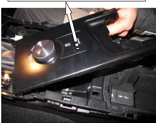
Снять верхнюю панель
