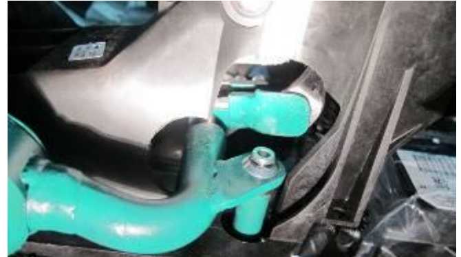
Перевести рычаг переключения передач в положение «R», произвести блокировку, отрегулировать положение хомута на тяге, сорвать винты
