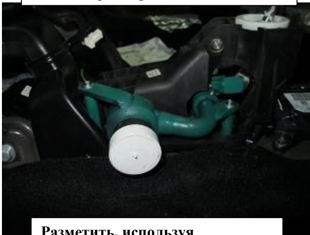
Установить защиту ригеля на трубу замка, зафиксировать винтом
