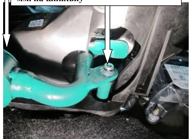
Установить замок на шестигранные столбики, зафиксировать 2 срывными болтами
