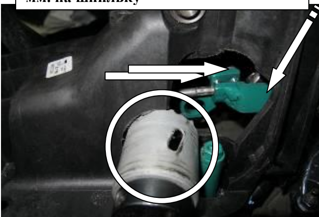
Удалить мешающий установке замка пластик селектора Установить хомут на тягу, зафиксировать 2 винтами (не срывать!!!)
