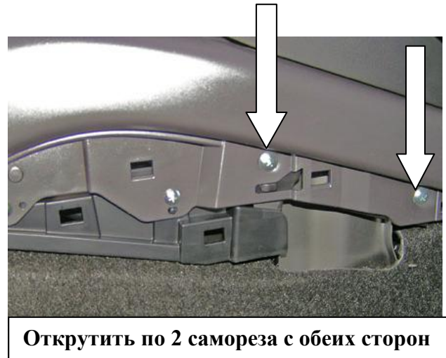
Открутить 2 самореза с обеих сторон
