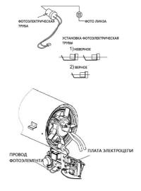
Рис 9 Положение фотоэлемента
