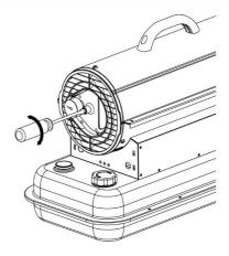
Рис. 11. Регулировка давления насоса
