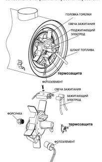
Рис 8. Замена форсунки и свечи зажигания СВЕЧИ ЗАЖИГАНИЯ:
