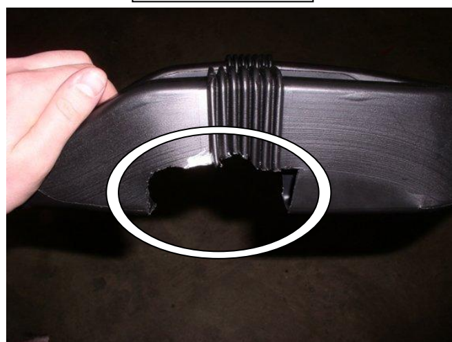
Удалить мешающую часть воздуховода
