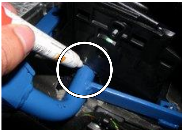
Установить замок на столбики, разметить отверстие в селекторе под трубу замка
