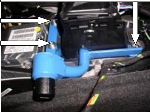
Повторно установить замок на место, закрутить 2 болта и гайку
