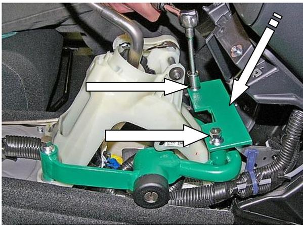
Установить защиту тяги на замок и столбик, закрутить 2 болта
