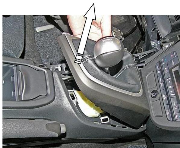
Снять верхнюю переднюю крышку
