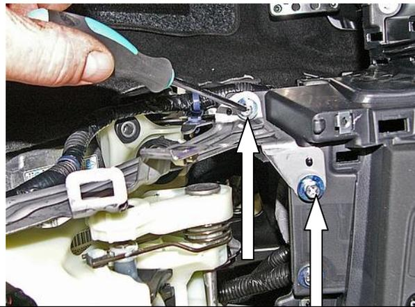
Открутить 2 болта, снять деталь селектора
