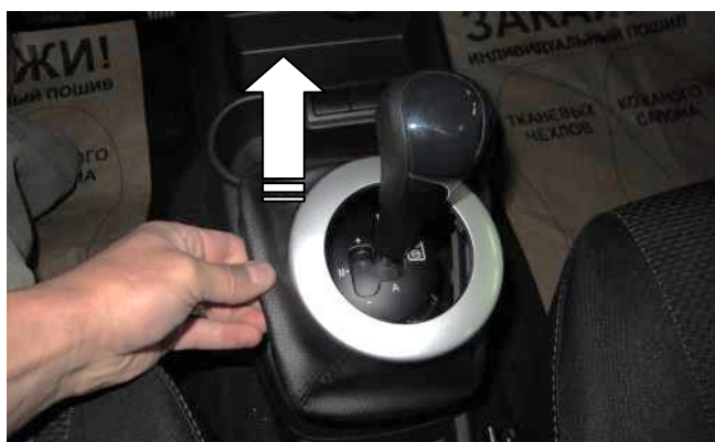
Снимите накладку рычага переключения передач КПП
