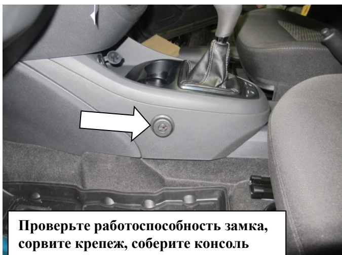
Установите шаблон SCH7 на корпус замка
