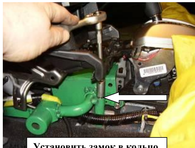
Установить замок в кольцо защиты, закрутить болт
