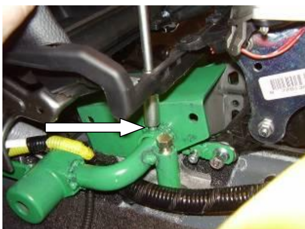
Зафиксировать трубу замка в кольце защиты
