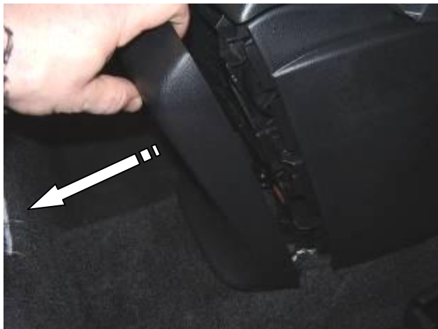
Снять заднюю крышку
