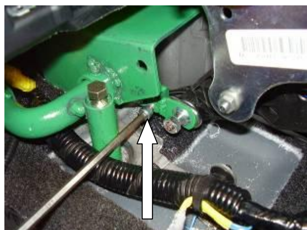
Дополнительно зафиксировать хомут на тяге
