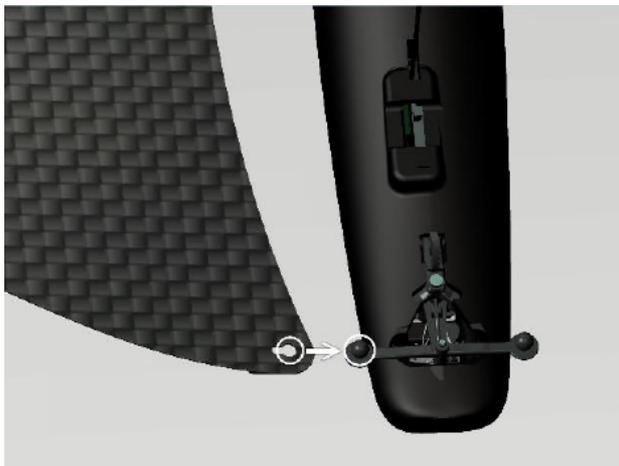
Переведите хвост птицы в крайнее верхнее положение. Возьмитесь за крыло возле заднего крепления и снимите его с этого крепления.
