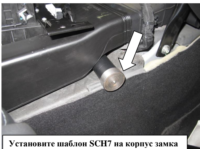
Разметьте и просверлите отверстие под корпус замка Ø32 мм
