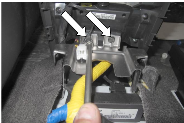
Открутите два болта крепления консоли
