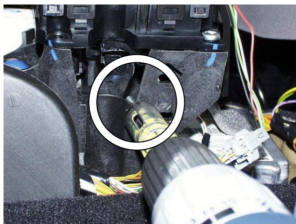
Просверлить отверстие в селекторе под трубу замка
