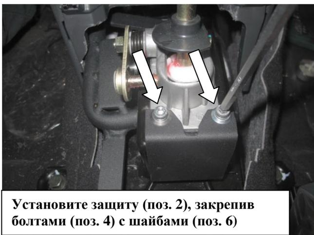
Установите защиту (поз. 2), закрепив болтами (поз. 4) с шайбами (поз. 6)
