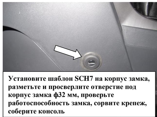
Установите шаблон SCH7 на корпус замка, разметьте и просверлите отверстие под корпус замка ф32 мм, проверьте работоспособность замка, сорвите крепеж, соберите консоль
