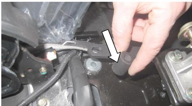
Установите замок (поз. 1), подложив под заднюю точку крепления деталь (поз. 3) и закрепив болтом (поз. 5) с шайбой (поз. 7)
