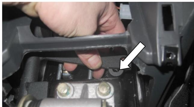
Подложите под переднюю точку крепления замка деталь (поз. 3) и закрепите болтом (поз. 5) с шайбой (поз. 7)
