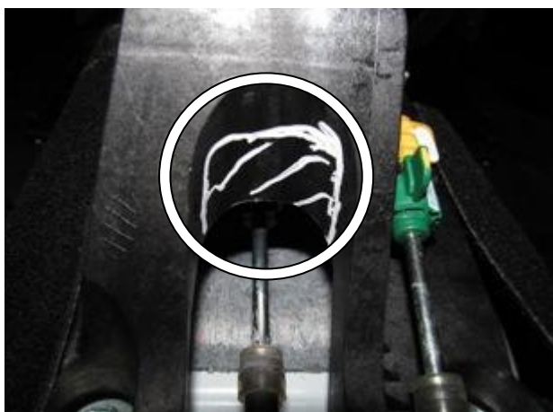
Разметить и удалить пластик селектора, мешающий установке хомута
