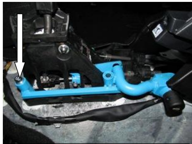
Снять воздуховод, установить замок, зафиксировать срывным болтом
