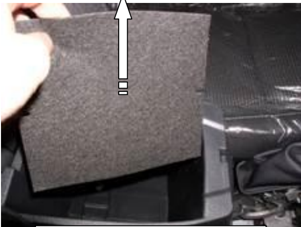
Поднять подлокотник, снять декоративную прокладку
