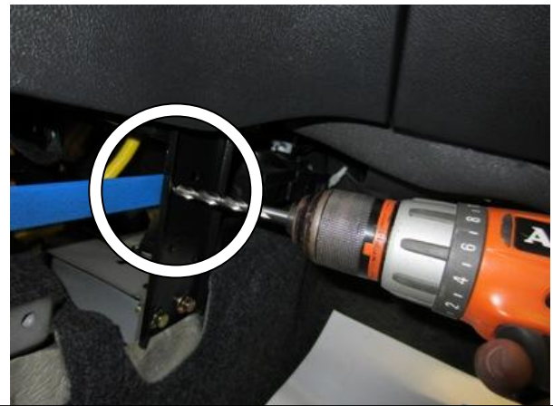
Просверлить отверстие 7 мм. в стойке селектора по отверстию в лапке замка (не повредить резьбу в отверстии лапки!!!)
