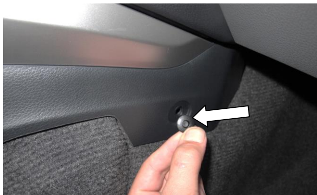
Извлеките по одному пистону крепления консоли с обеих сторон
