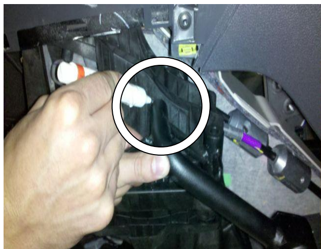
Установить замок на столбики, разметить отверстие в селекторе под трубу замка
