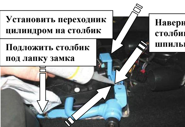
Загерметизировать зазор между цилиндром и столбиком, установить замок на переходник
