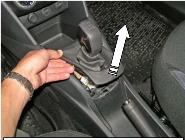
Снять декоративный чехол рычага
