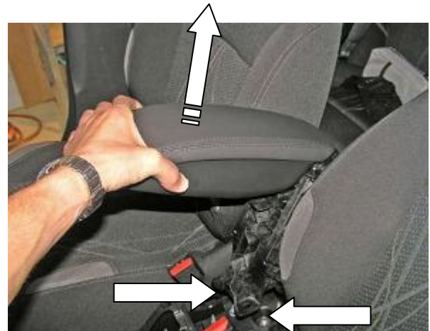
Открутить 2 самореза, снять подлокотник
