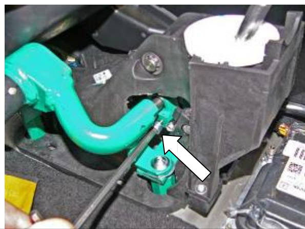
Перевести рычаг переключения передач в положение «R», произвести блокировку, при необходимости отрегулировать положение хомута на тяге, сорвать винт
