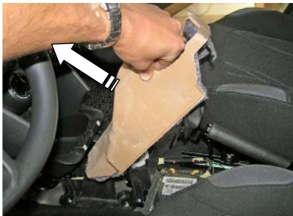
Снять звукоизоляционный чехол селектора
