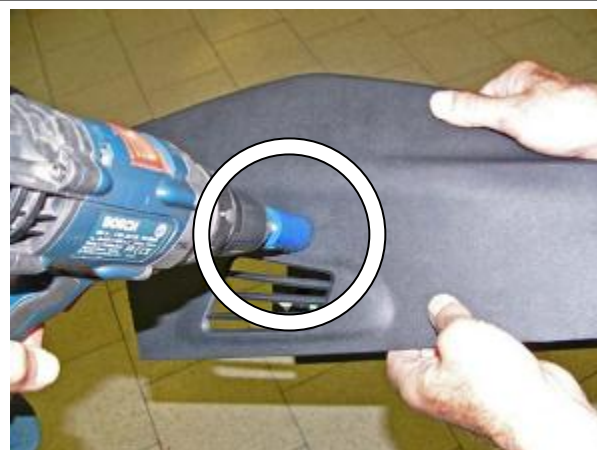
Расширить отверстие до 32 мм.
