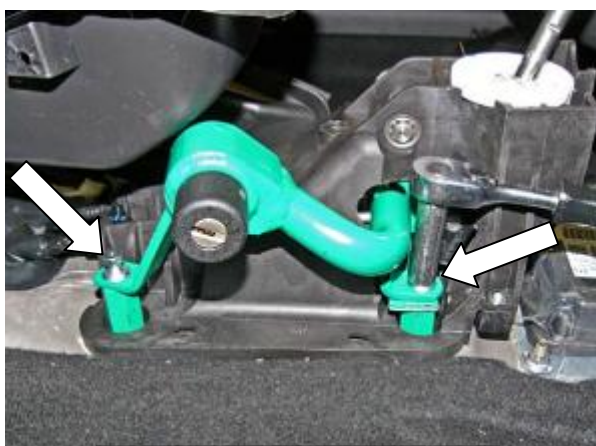
Закрутить срывной болт
