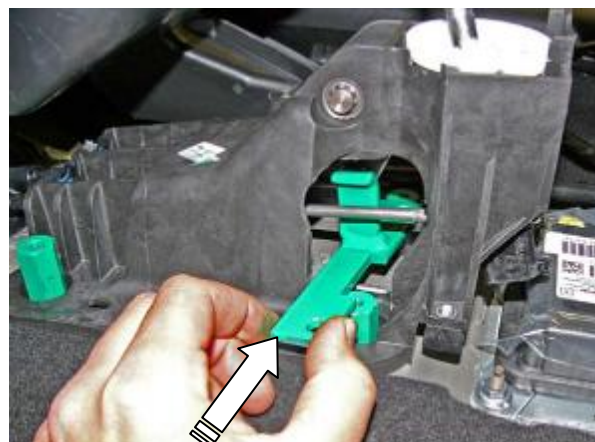
Установить защиту ригеля на столбики
