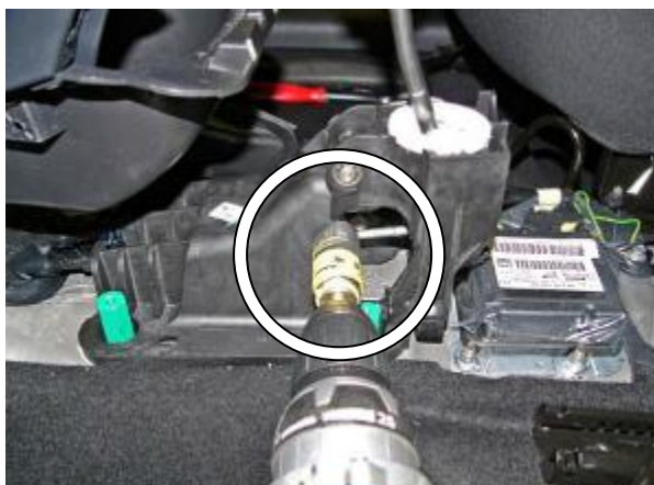
Удалить мешающий пластик селектора
