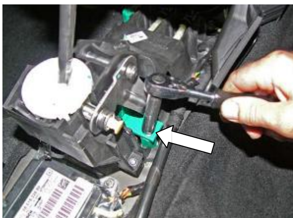
Закрутить срывной болт
