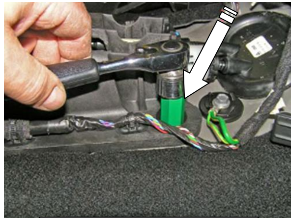
Установить шестигранный столбик на шпильку
