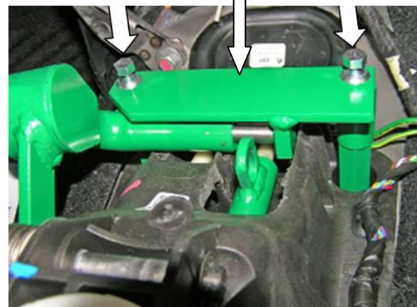
Установить защиту тяг на столбик замка и цилиндрический столбик, закрутить 2 срывных болта
