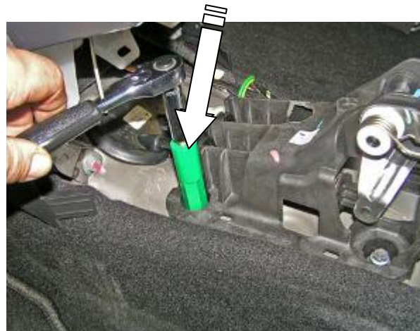
Установить цилиндрический столбик на шестигранный, зафиксировать болтом
