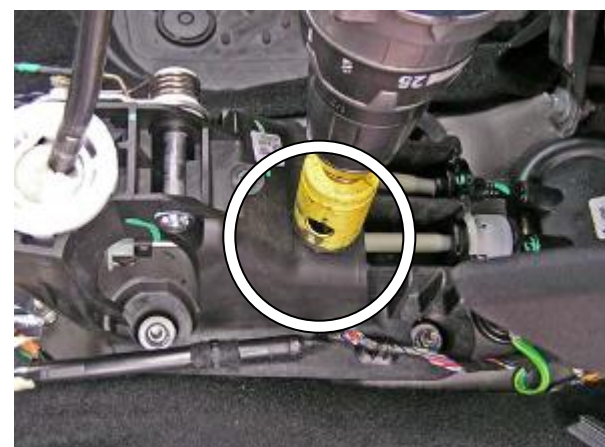
Удалить мешающий установке хомута пластик селектора
