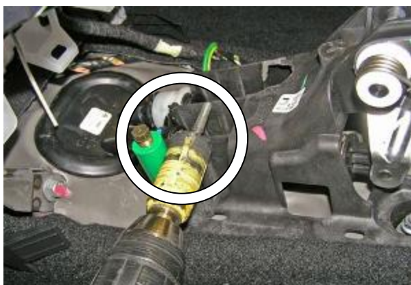
Профрезеровать отверстие в селекторе под трубу замка, ориентируя фрезу по цилиндрическому столбику, а направляющую фрезы – по верхнему краю селектора
