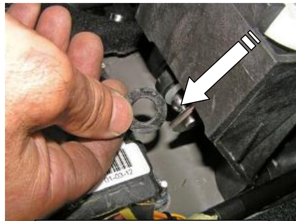
Установить большую шайбу, вернуть тягу на место
