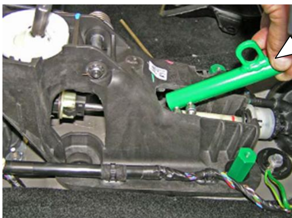
Установить хомут на тягу
