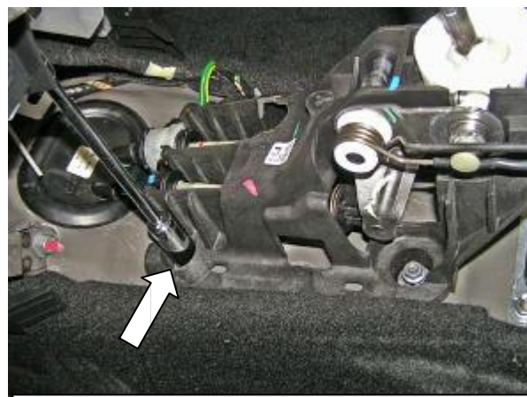
Открутить штатную гайку селектора
