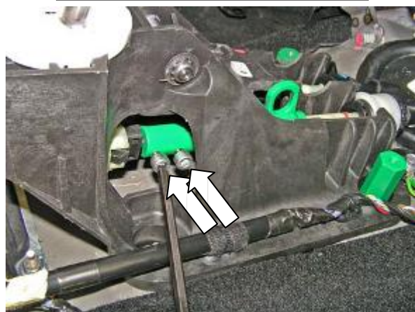
Зафиксировать хомут 2 винтами (не срывать!!!)
