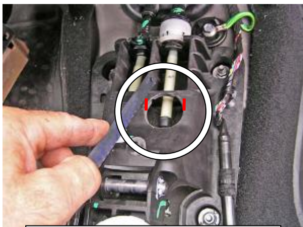
Удалить мешающий установке хомута пластик селектора
