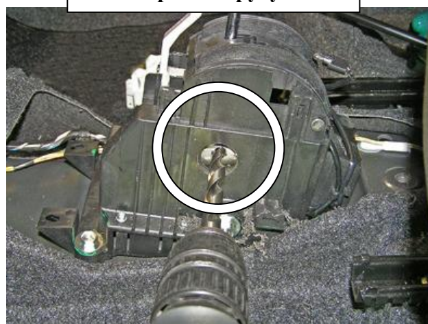
Просверлить отверстие в рычаге переключения передач под ригель замка
