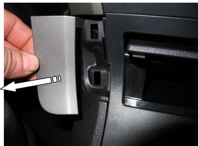
2 Снять декоративные панели с обеих сторон
