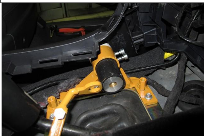
Разметить отверстие в консоли под прямоходный цилиндр
