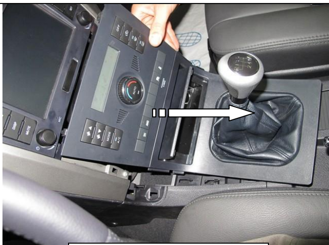
3 Снять переднюю панель
