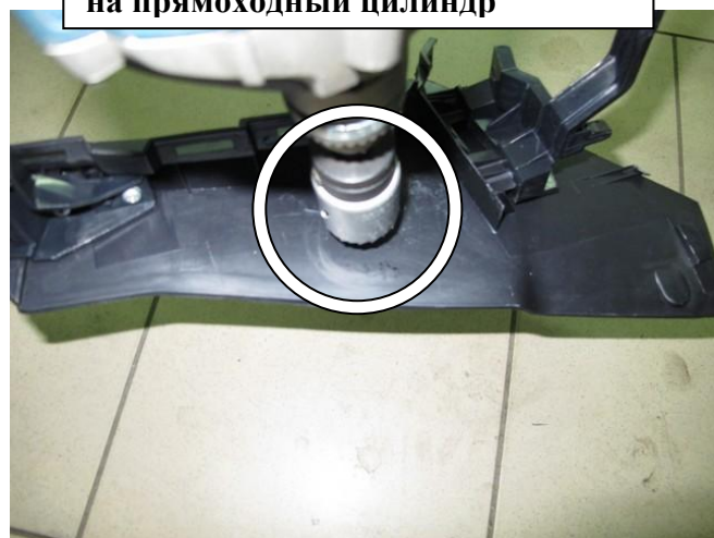
Просверлить и расширить отверстие
