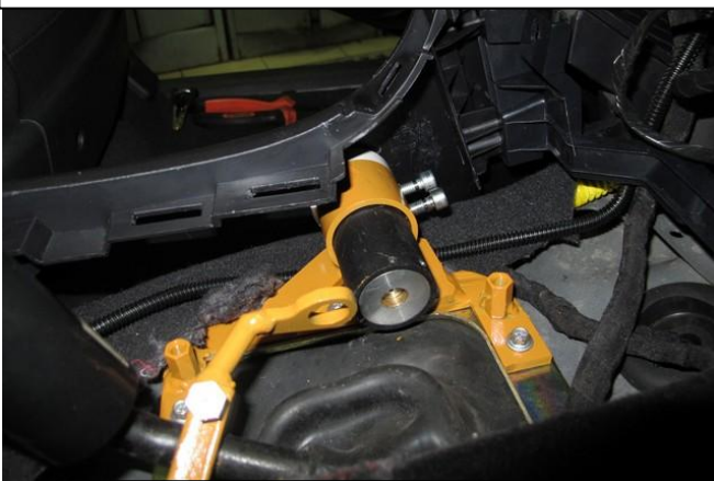
Разметить отверстие в консоли под прямоходный цилиндр
