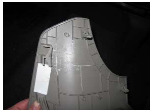
Удалите ребра жёсткости в месте выхода цилиндра замка
