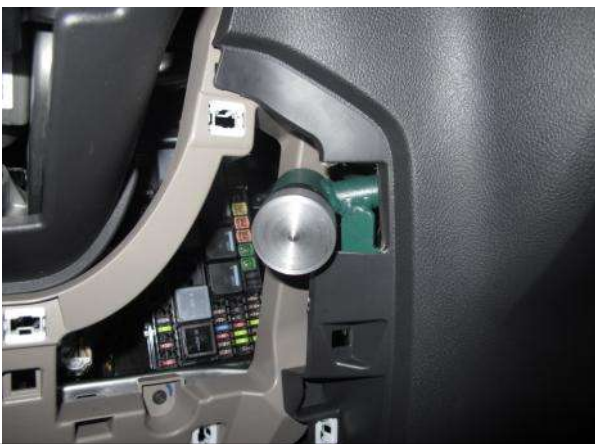
Установите шаблон на корпус замка
