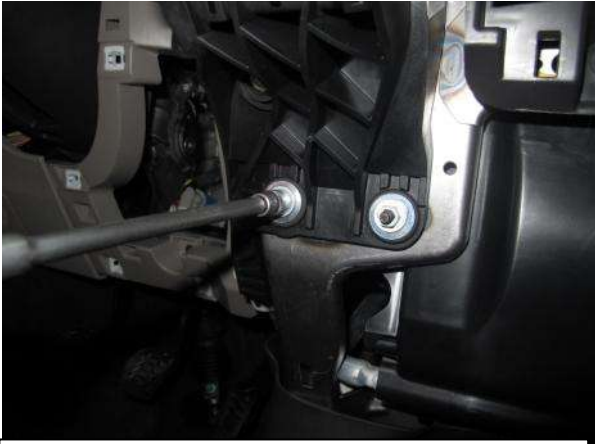
Открутите две гайки крепления селектора
