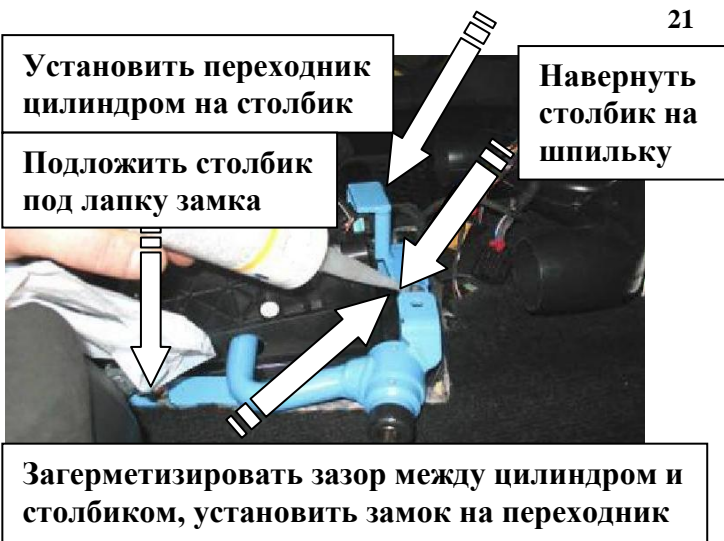
Установить деталь поверх замка
