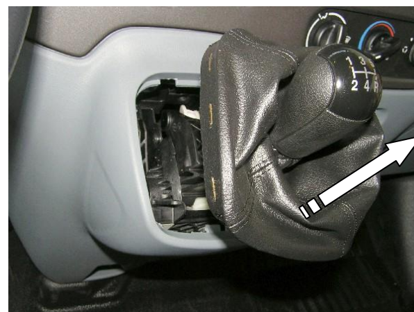
Снять декоративный чехол рычага переключения передач
