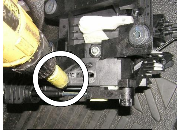
Просверлить отверстие в селекторе под трубу замка
