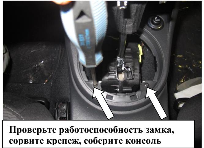
Проверьте работоспособность замка,
