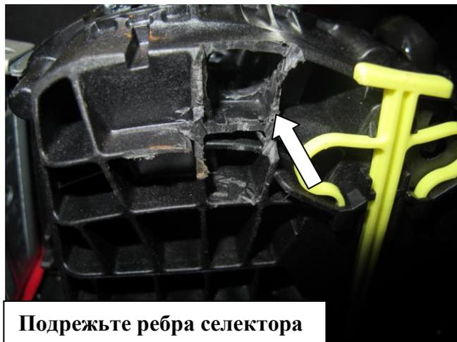
Подрежьте ребра селектора
