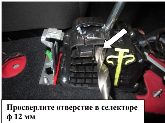
Просверлите отверстие в селекторе
