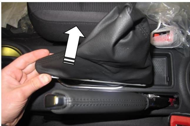
Снимите чехол рычага ручного тормоза
