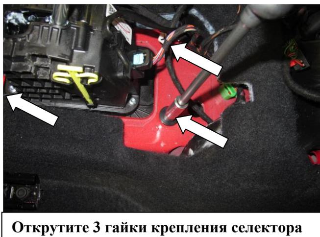
Открутите 3 гайки крепления селектора
