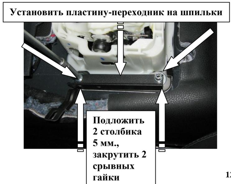
Установить пластину-переходник на шпильки
