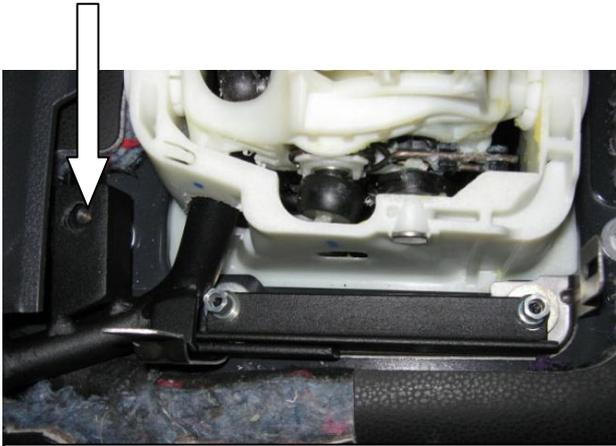
Установить замок на пластину-переходник, закрутить срывной болт
