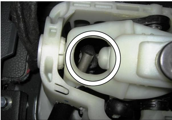
Перевести рычаг переключения передач в положение «R», произвести и проверить блокировку
